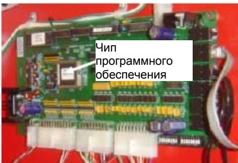
Рисунок 3. Главная печатная плата Gen 5
